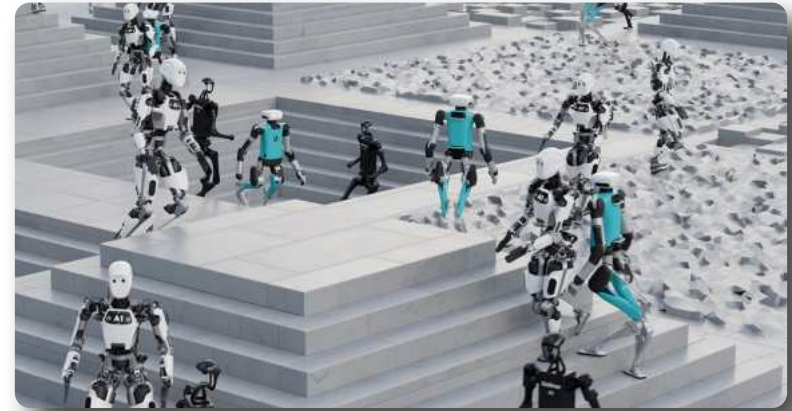
Nvidia Isaac addestra robot in simulazioni virtuali ultra-realistiche. Un braccio robotico, ad esempio, impara a manipolare oggetti ricevendo ricompense per le prese riuscite, sviluppando abilità complesse in modo sicuro prima di trasferirle al robot fisico nel mondo reale.
